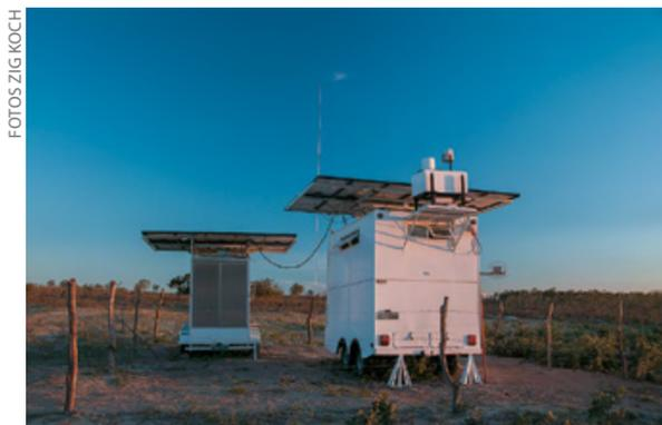
FIGURA 4.10 Equipamento LIDAR instalado sobre trailer de transporte em operação.
