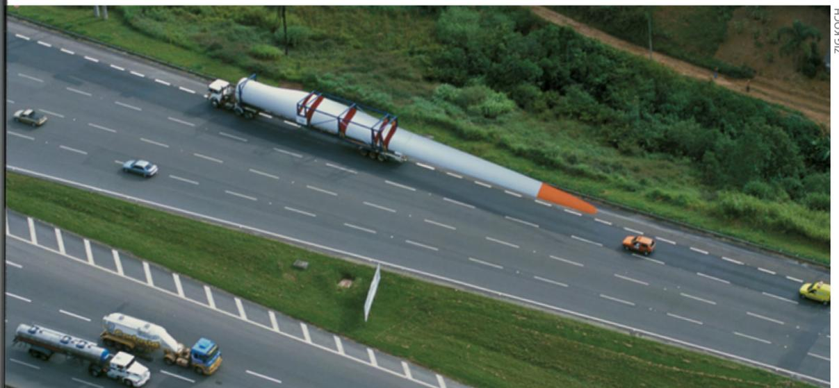
FIGURA 4.7 Transporte de pás de rotor eólico de diâmetro superior a 100 m.
